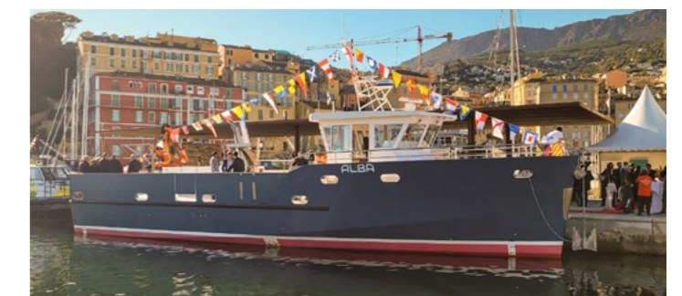
Inauguration en novembre du navire Alba. Sa raison d'être ? Illustrer l'avenir et la transition énergétique pour répondre aux besoins des professionnels de la mer. Propulsé par un dispositif hybride composé de deux systèmes piles à combustible et de deux packs de batteries, il sera capable d'atteindre 13,5 nœuds avec ses 12 élèves et 2 membres d'équipage, avec une autonomie de 12h ou 100 milles nautiques.
