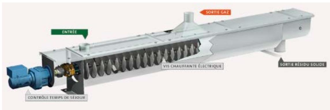
Figure 12 : Schéma de fonctionnement de la vis chauffée Spirajoule®
