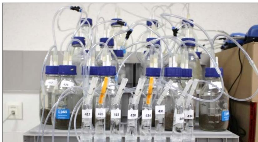
Figure 62 : Dispositif pour l'évaluation de la volatilisation ammoniacale (1 bloc de 8 chambres de volatilisation)
