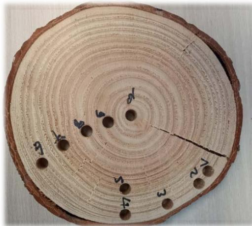
Figure 48 : Identification des différentes zones d'échantillonnage dans les biomasses de type bois (ici douglas)
