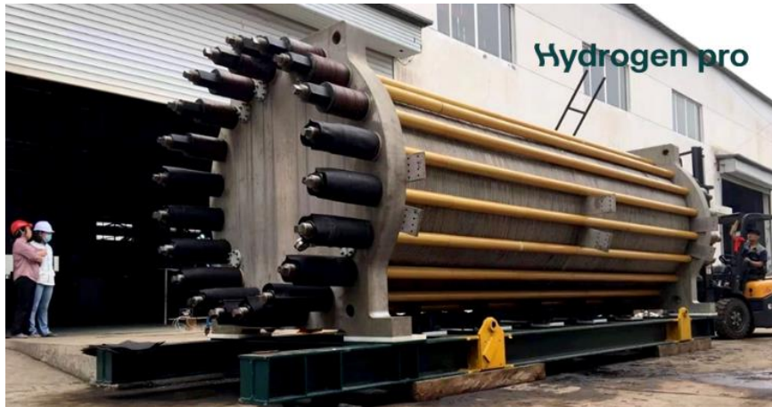
Figure 15 – L'électrolyseur Hydrogen PRO de 1 100 Nm 3 /h (2022)
