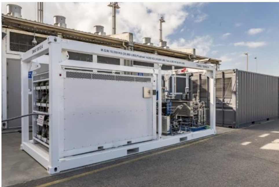
Figure 7 – le système réversible SOEC/SOFC de Boeing (2016)
