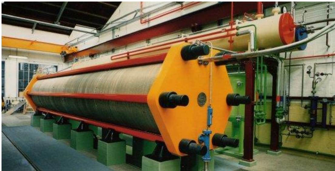
Figure 13 – Electrolyseur alcalin ELT type S 556, 760 Nm 3 /h – 30 bars
