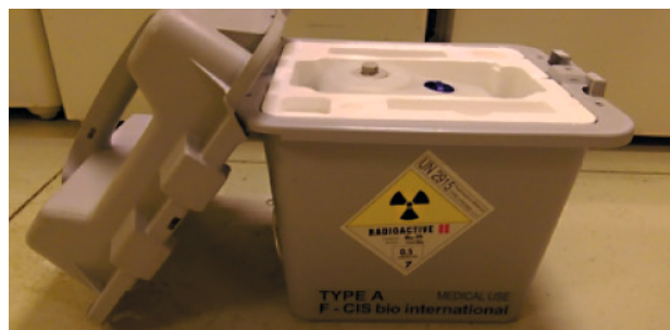
Conteneur de transport de générateur de technétium
