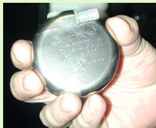
Pacemaker au plutonium
