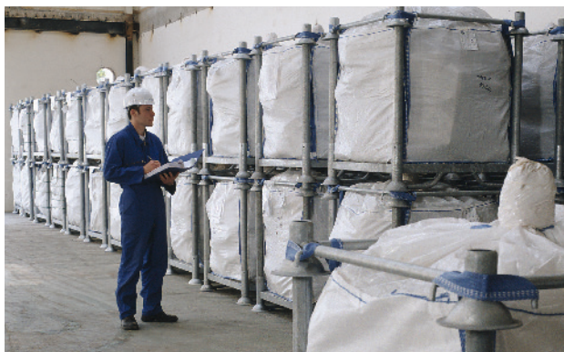
Entreposage de déchets de très faible activité (TFA) provenant du démantèlement du réacteur de recherche Triton
